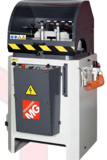
El rango de máquinas TLG para corte de Aluminio y PVC con disco de Ø350 mm y giro a grados desde 0° hasta 180° y torreta desplazable hasta 130mm para lograr más capacidad de corte TLG-352-M » Pisador manual, Lubricación manual y subida de disco manual TLG-352-SA » Pisadores neumáticos, Lubricación automática y subida de disco manual TLG-352-A » Pisadores neumáticos, Lubricación automática y subida de disco automática
